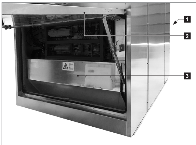
Фиг. 20: По време на доставка защитната плоча на вентилатора се закрепва временно с 4 винта.
