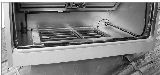
Фиг. 29: Филтър за засмуквания въздух, монтиран в апарата
