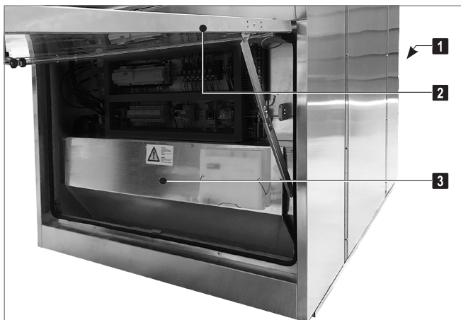
Фиг. 14: По време на доставка защитната плоча на вентилатора се закрепва временно с 4 винта.
